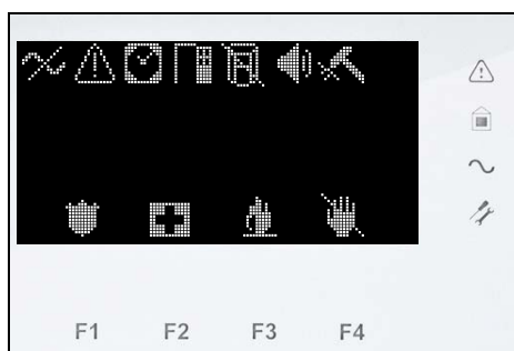
Figura 4 - Display e icone di stato della tastiera KP500DP/N
